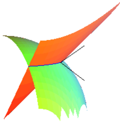
Figura 4.1: Intersecção das duas superfícies g(x, y, z) = 0 e h(x, y, z) = 0 com os vetores normais
